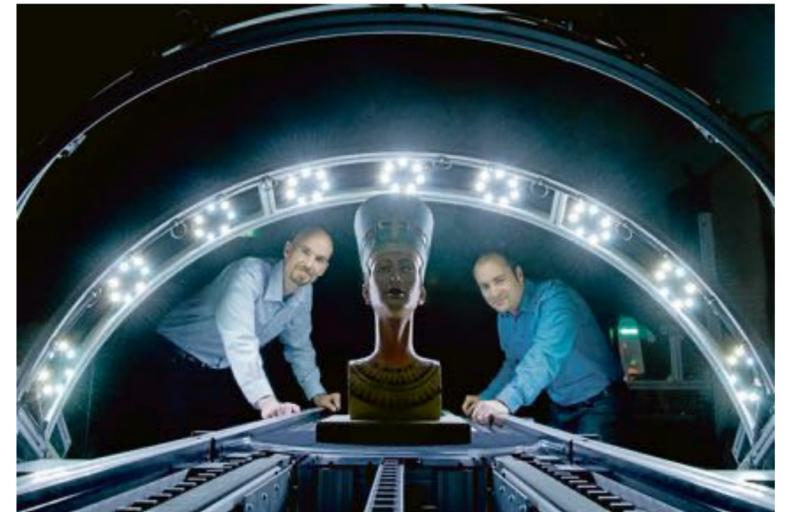
Digitalisierung in Darmstadt: Forscher des Fraunhofer-Instituts entwickelten einen 3-D-Scanner.
